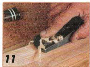
После высыхания клея всю поверхность еще раз выравнивают рубанком, снимая стружку минимально возможной толщины. Использовать для выравнивания поверхности шкурку нежелательно, так как это может привести к загрязнению светлых деталей рисунка.
