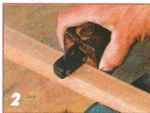
Канавки выбирают в несколько проходов, не прикладывая излишних усилий.
