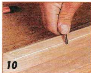
Сняв выступающую часть полоски рубанком, необходимо сделать по ней несколько продольных проходов стальным полировальником, каждый раз увеличивая силу нажима.
