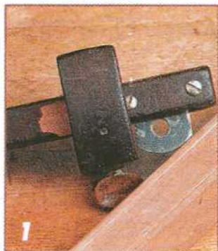
Стружок для выборки прямых канавок, параллельных краю изделия, сделан из старого рейсмуса и обломка ножовочного полотна.
