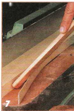
Заготовки полос нарезают на стационарном дисковом распиловочном станке. Если на станке не установлен специальный раскливающий нож, то отрезаемую полосу на выходе нужно обязательно придерживать.
