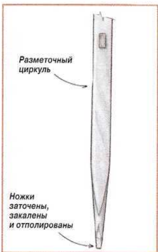
Рис. 4. Заточка одной из ножек слесарного разметочного циркуля. После заточки острие следует закалить и отполировать.
