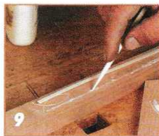
Вклеивать полоски нужно быстро и аккуратно, так как вода, содержащаяся в клее, вызывает заметное набухание миниатюрных деталей и изменение их размеров.
