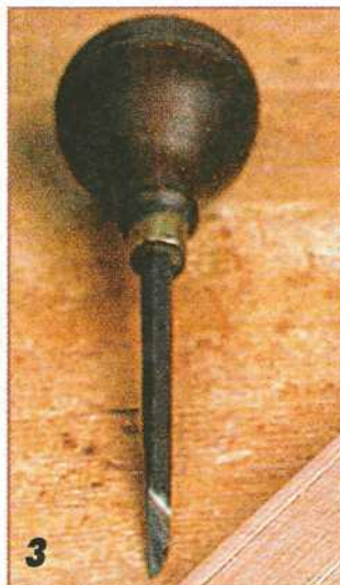
Штихель для выборки углов и зачистки концевых участков канавок можно сделать из старого напильника, сломанного напильника или отслужившей свое отвертки.
