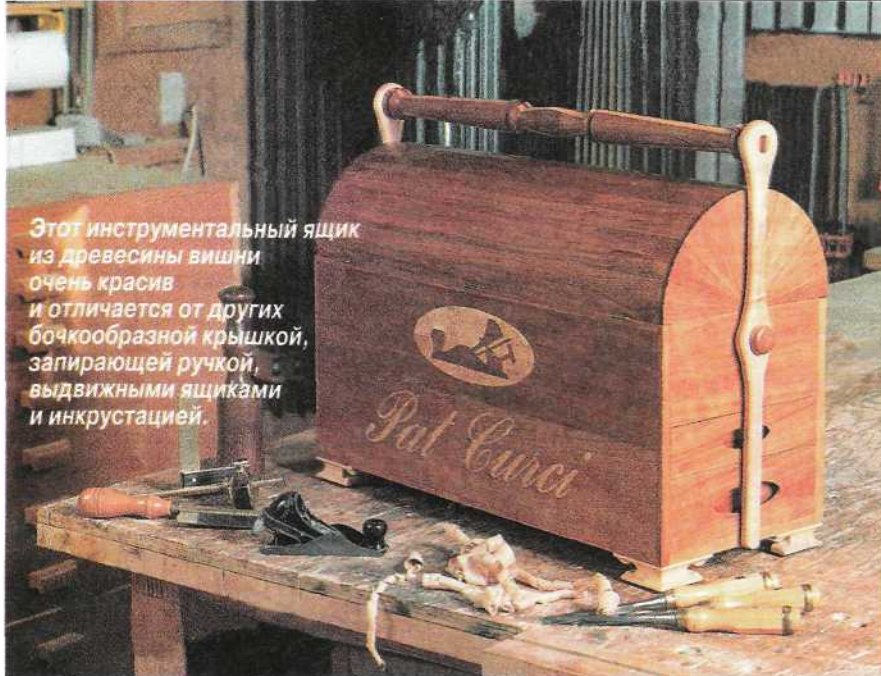
Поворотом ручки вниз открывают доступ к выдвижным ящикам и раскрывают крышку. Под ней находится глубокий ящик для инструментов больших размеров.
