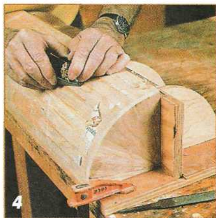
Подгонка планок крышки. Торцевым рубанком протруживают выступающие ребра планок. Качество и форму поверхности оценивают на глаз и на ощупь.
