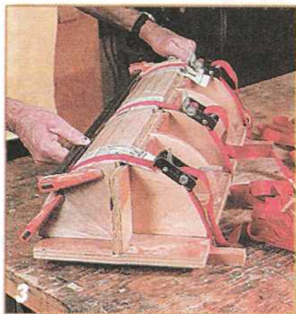
Фанерный лоток упрощает склейку. Чтобы сплотить планки и быстро прижать их четвертям на торцевых стенках, используйте телоточные зажимы.
