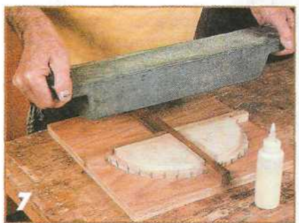
Приклеивают подложки к планкам — «солнечным лучам». Подложки укладывают на «солнечные лучи» встык к направляющим и прижимают тяжёлым грузом.
